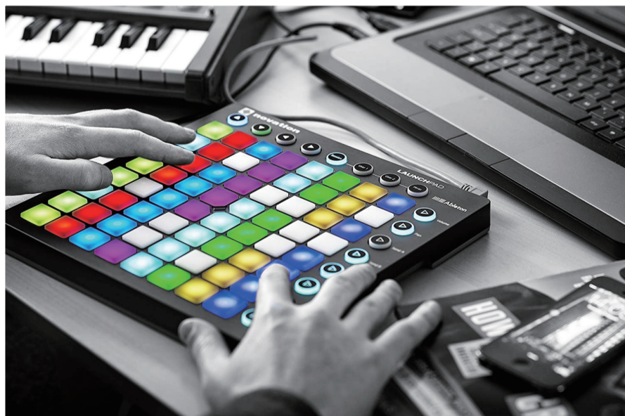
LAUNCHPAD 的原理就是把一些不同的音樂設置在不同的方格上然後按動不同的方格按鈕來製作聲音。(資料來源：novationmusic)
